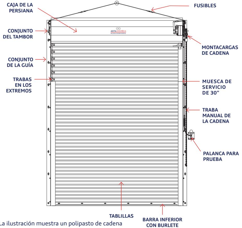
La ilustración muestra un polipasto de cadena con motor Grifco opcional y eslabones fusibles.
