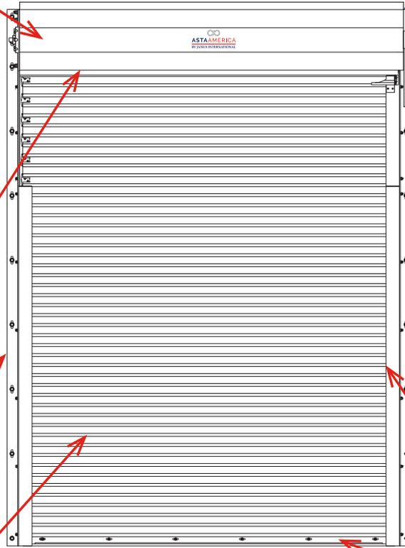
**Conjunto del Soporte** | Las placas de soporte son de acero con un espesor mínimo de 1/4" (6.35mm) y contienen los extremos del conjunto del tambor. La placa de soporte del extremo de la transmisión lleva en su interior un rodamiento de bolas autoalineable sellado.
